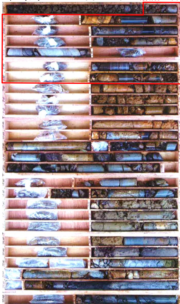
1, 2号炉建設時の埋戻土 ボーリングNo. P11 0.8m~7.0m 埋戻土(掘削ズリ)
