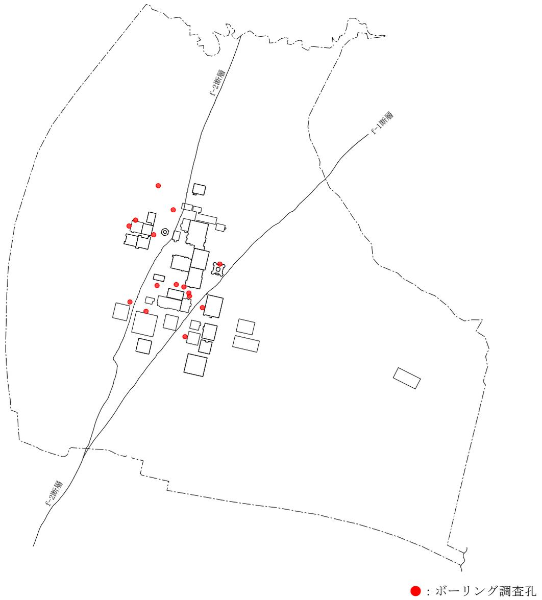
第 5.1-1 図 埋戻し土の地盤物性値の設定に用いているボーリング調査孔の位置図
