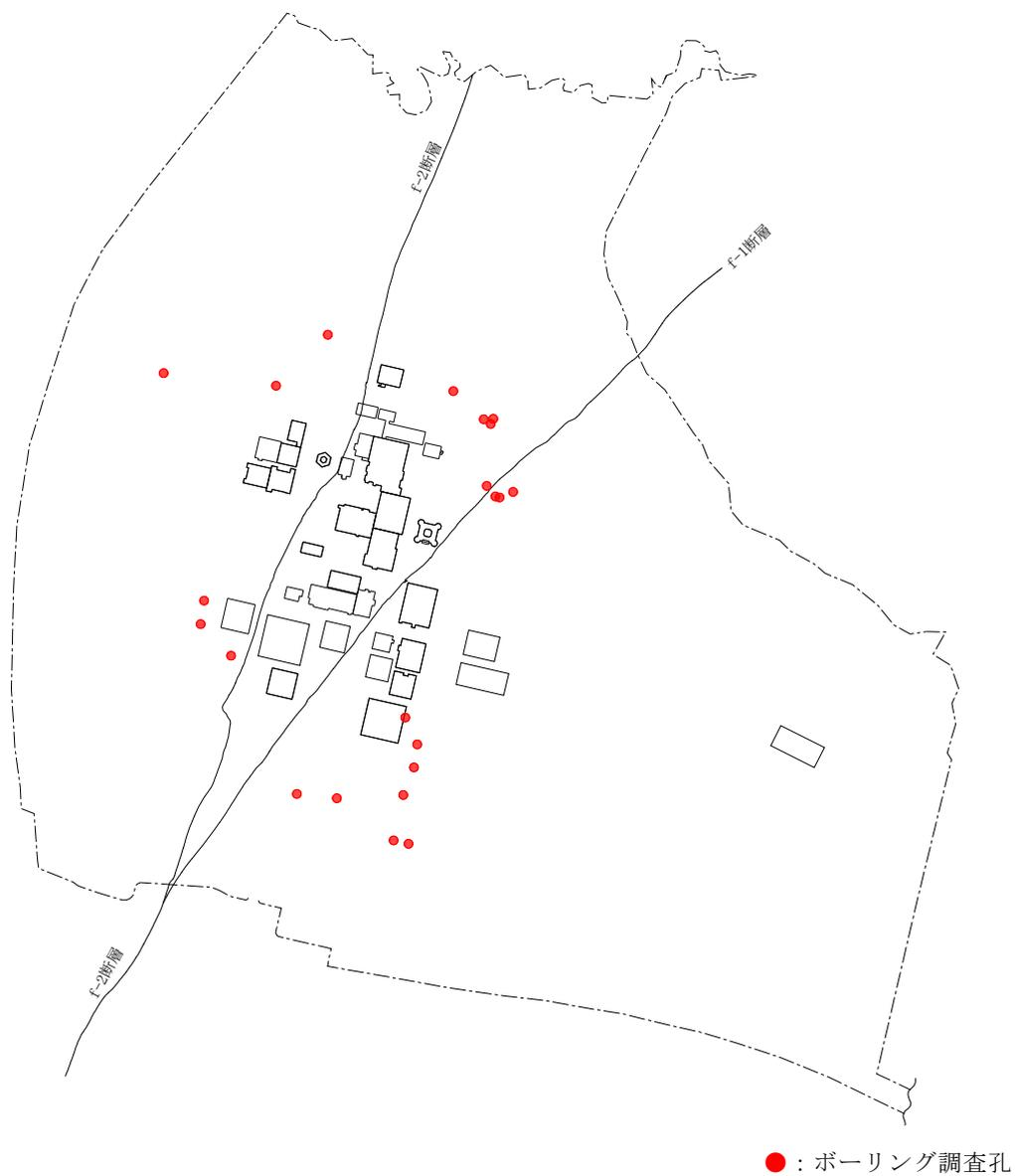
第 5.2-1 図 造成盛土の地盤物性値の設定に用いているボーリング調査孔の位置図
