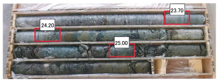
改良地盤における試験位置のボーリングコア
