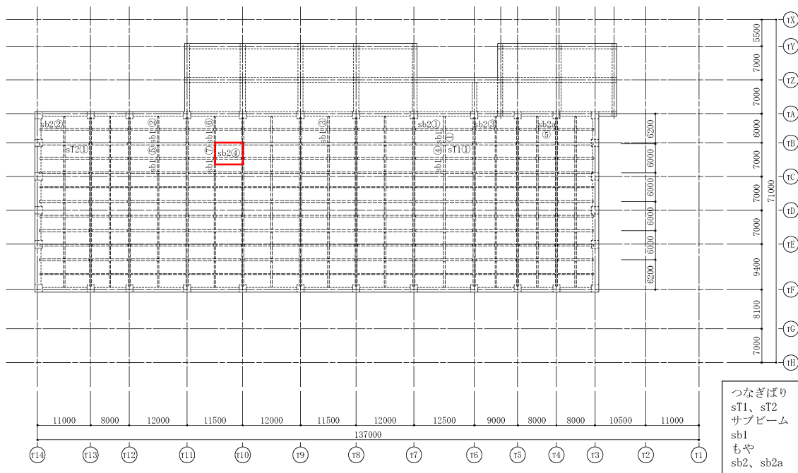
第 3-3 図 部材位置図 (トラス二次部材：母屋)
