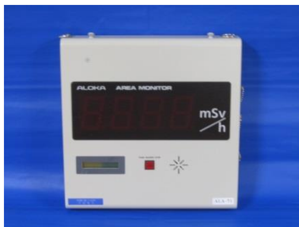
第 5.2-1 図 可搬式エリア放射線モニタ
