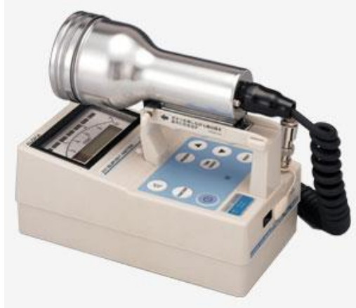
第 5.2-2 図 GM汚染サーベイ・メータ
