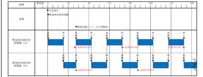
第3図 緊急時対策所用発電機の給油時間
