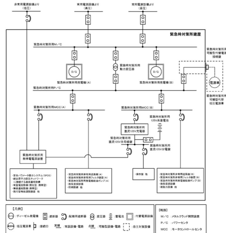
第 1.18.2.4-1 図 緊急時対策所電源系統概略図
