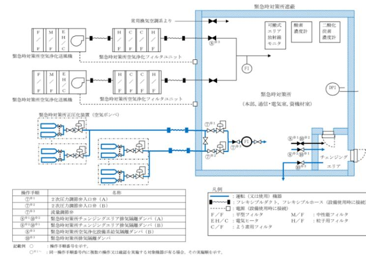
第2図 緊急時対策所換気空調設備系統概要図(プルーム通過中:緊急時対策所正圧化装置(空気ポンプ)による正圧化時)
