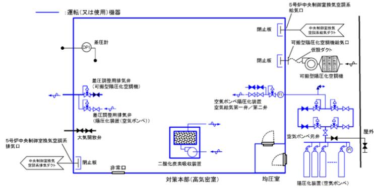
第3図 5号炉原子炉建屋内緊急時対策所(対策本部)換気設備系統概略図(プルーム通過中:陽圧化装置(空気ポンプ)による陽圧化)
