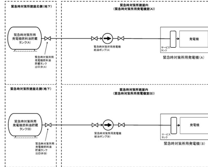
第 1. 18. 2. 4-2 図 緊急時対策所燃料系統概略図
