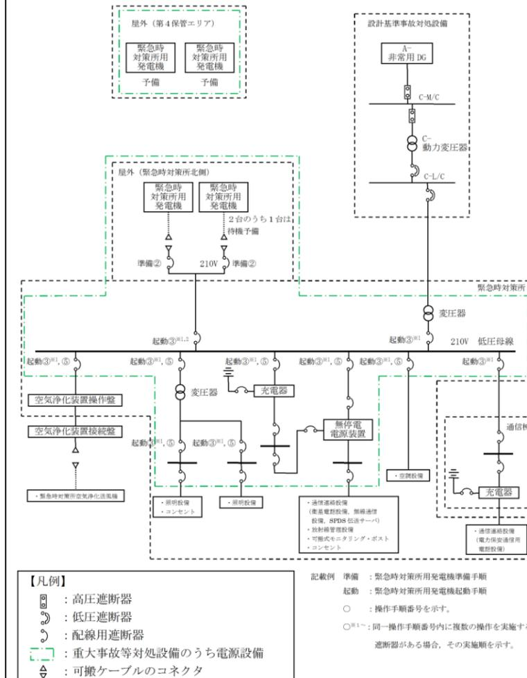
第1図 緊急時対策所 電源構成
