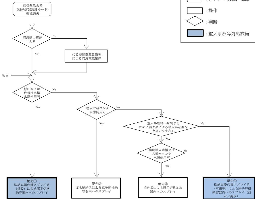
原子炉格納容器の破損を防止するための対応手段
