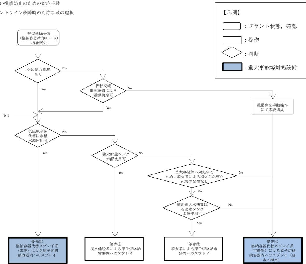
炉心の著しい損傷防止のための対応手段
