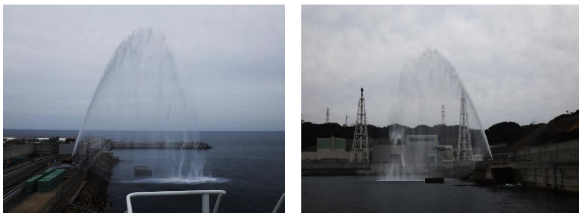
第4図 直状放射による放水
