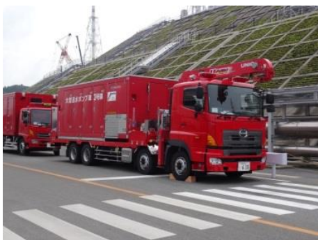
大型送水ポンプ車
