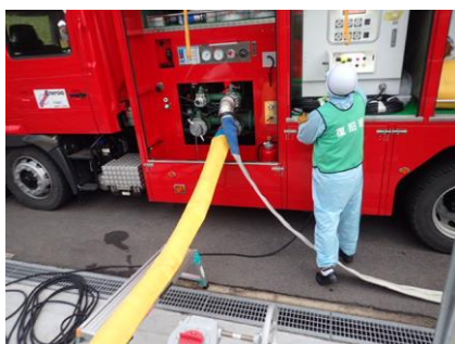
大量送水車起動
