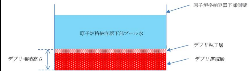
図3 デブリ堆積高さの概念図
