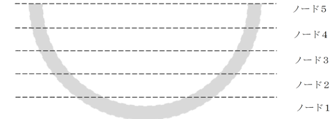
図1 原子炉压力容器下部ヘッドのノード分割 (概念図)
