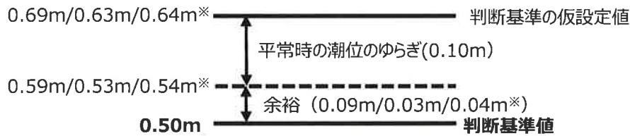
第 3-4 図 取水路防潮ゲートの閉止判断基準の概念図
