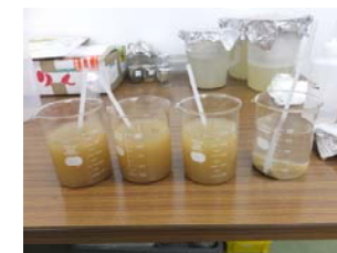
ビーカーを用いた水簸の例
