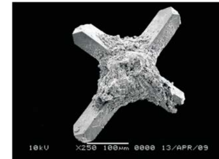
Adisaputra and Kusnida(2010) 十字状の形態をなすフィリップサイトのSEM画像
