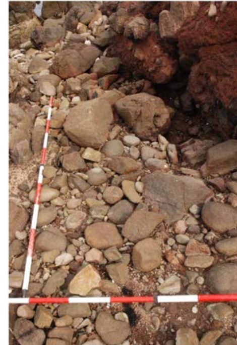
敷地前面海岸(B地点) 礫形調査位置 ・亜円～亜角礫主体で円礫も混じる
