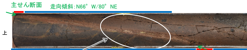
下ブロック採取箇所 粘土状破砕部 固結した破砕部 ボーリングコア写真(H-6.6-1孔)
