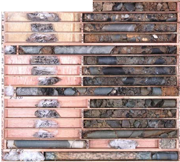
1, 2号炉建設時の埋戻土 ボーリングNo. E-5 1.5m~16.1m
