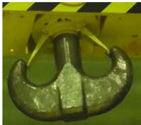
第 5. 2. 15 図 主巻のワイヤロープ二重化構造及び主巻，補巻のフック構造
