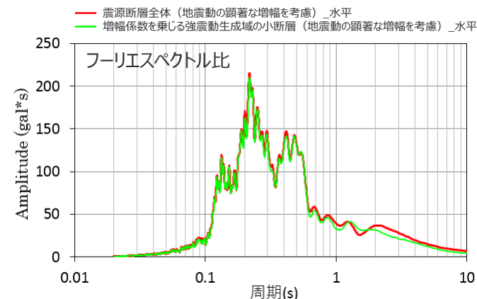
<震源断層全体の地震動と増幅係数に乗じる強震動生成域の地震動のフーリエスペクトル※> (地震動の顕著な増幅を考慮する場合)
