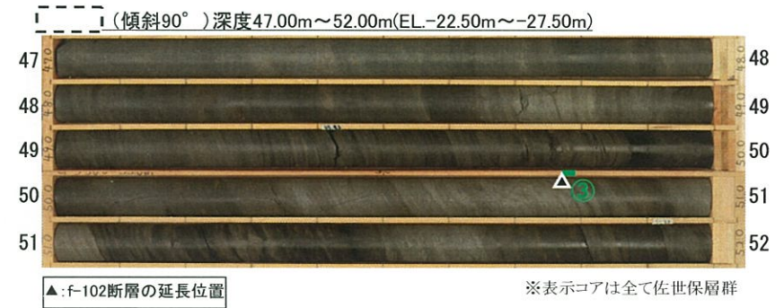
f-102断層延長位置付近のコア写真
