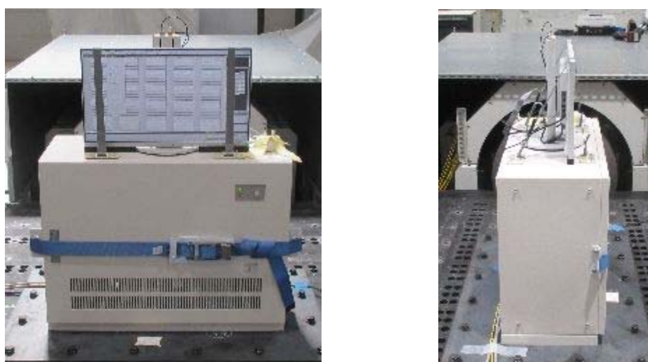
図1 火災受信機盤②の設置イメージ
