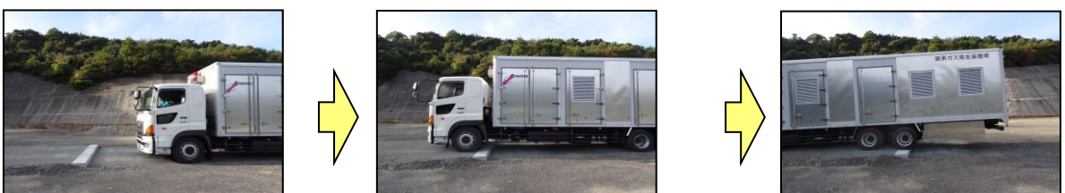
第2図 段差復旧前の走行性能検証(1/2)
