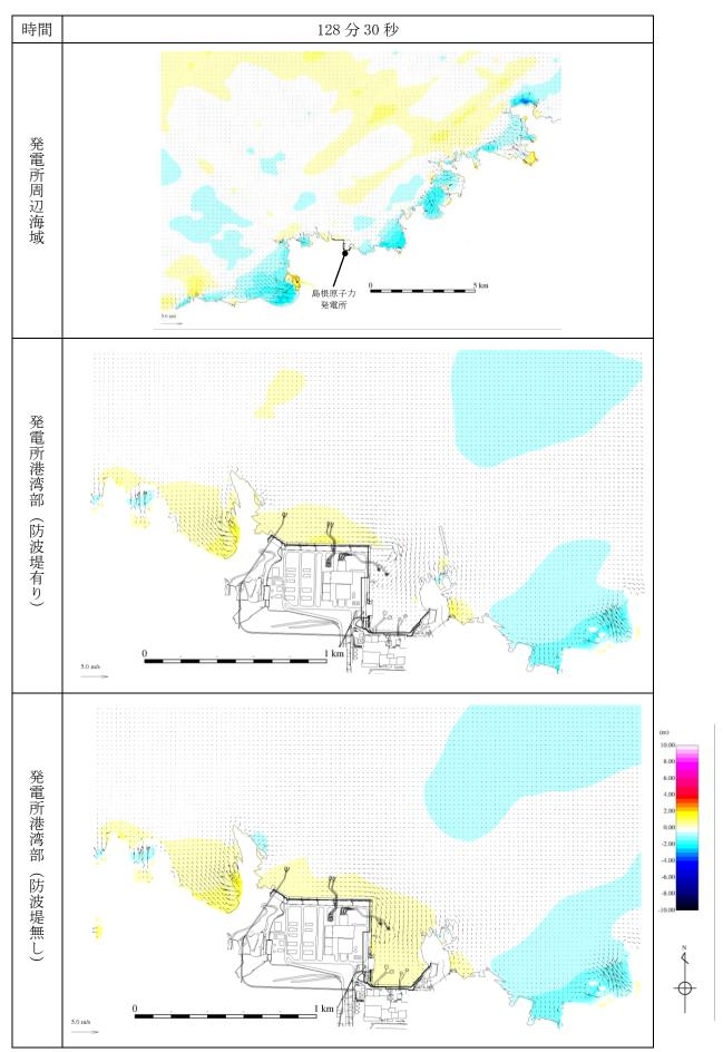
第 1 図(58) 基準津波 1 の水位変動・流向ベクトル
