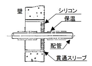
第4.2-18図 充填構造 (シリコン) の概要
