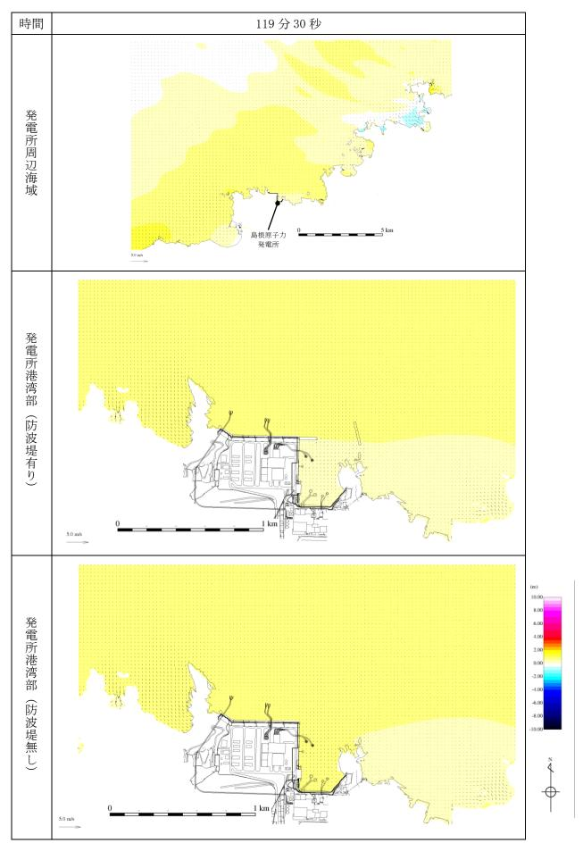
第 1 図(40) 基準津波 1 の水位変動・流向ベクトル
