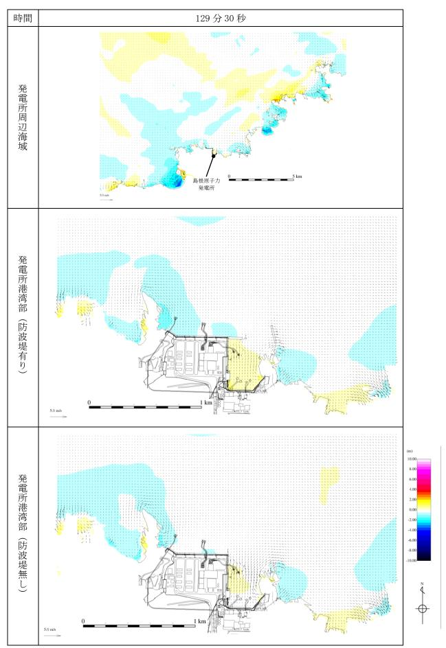
第 1 図(60) 基準津波 1 の水位変動・流向ベクトル
