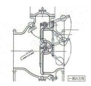
第4.2-17図 タービン補機海水系放水配管逆止弁 構造例
