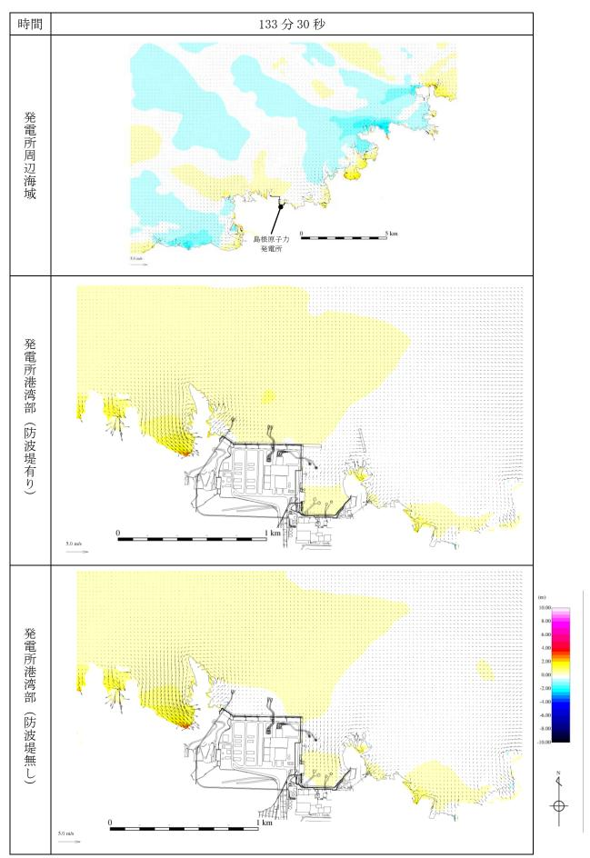
第 1 図(68) 基準津波 1 の水位変動・流向ベクトル
