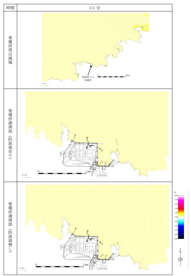
第 1 図(23) 基準津波 1 の水位変動・流向ベクトル
