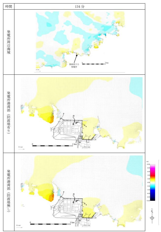
第 1 図(69) 基準津波 1 の水位変動・流向ベクトル
