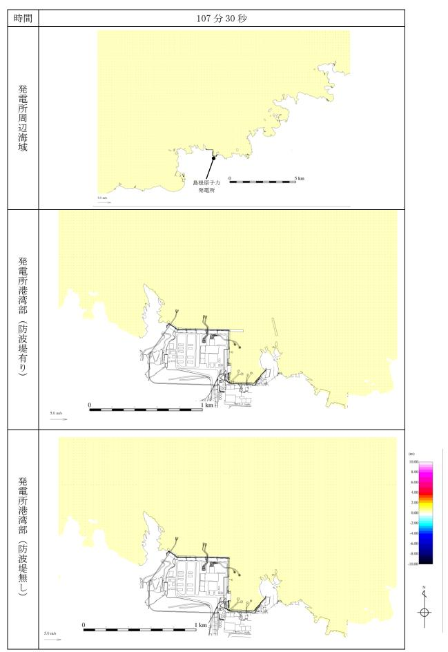
第 1 図(16) 基準津波 1 の水位変動・流向ベクトル
