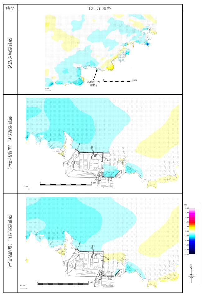
第 1 図(64) 基準津波 1 の水位変動・流向ベクトル
