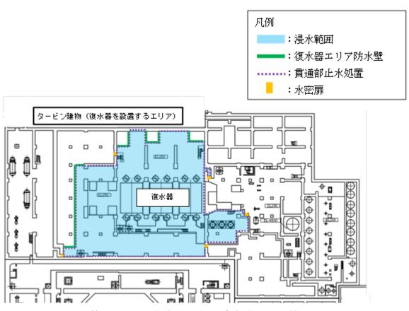
第4.2-6図 復水器エリア防水壁 設置位置
