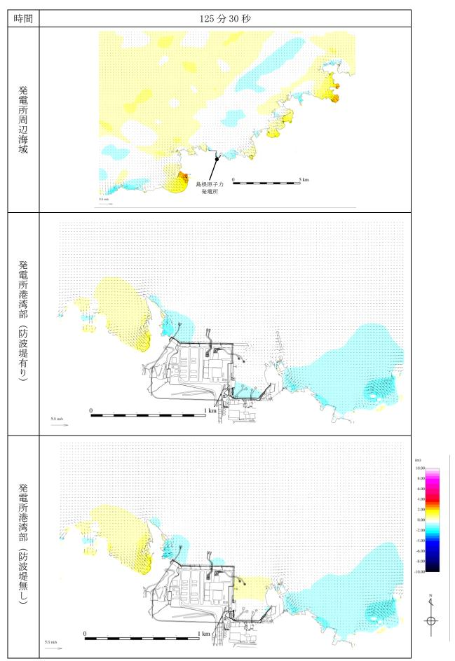
第 1 図(52) 基準津波 1 の水位変動・流向ベクトル
