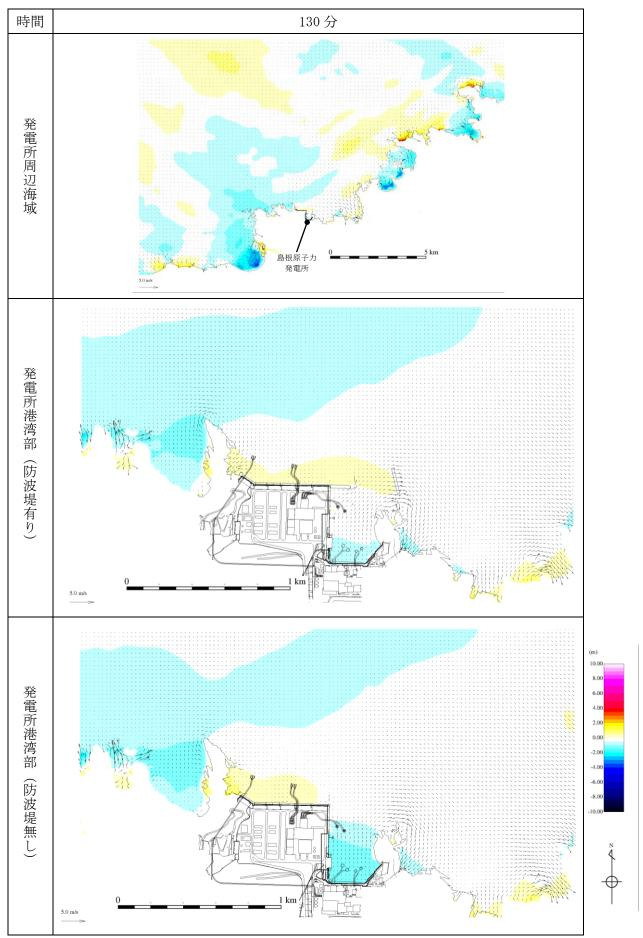
第 1 図(61) 基準津波 1 の水位変動・流向ベクトル
