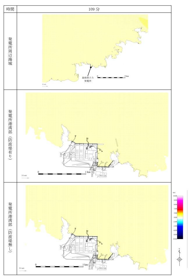
第 1 図(19) 基準津波 1 の水位変動・流向ベクトル
