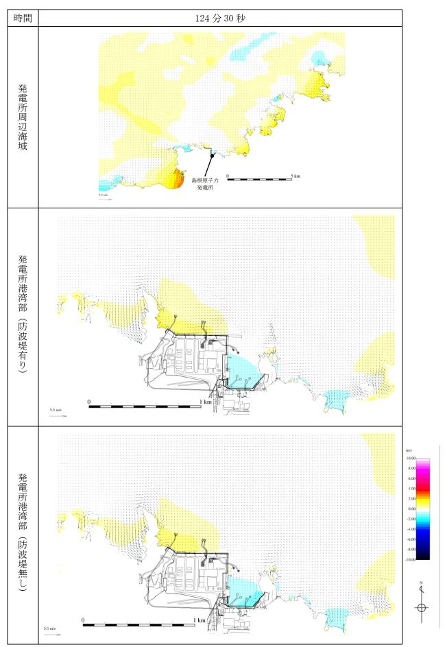
第 1 図(50) 基準津波 1 の水位変動・流向ベクトル
