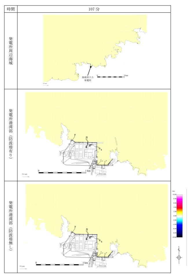
第 1 図(15) 基準津波 1 の水位変動・流向ベクトル
