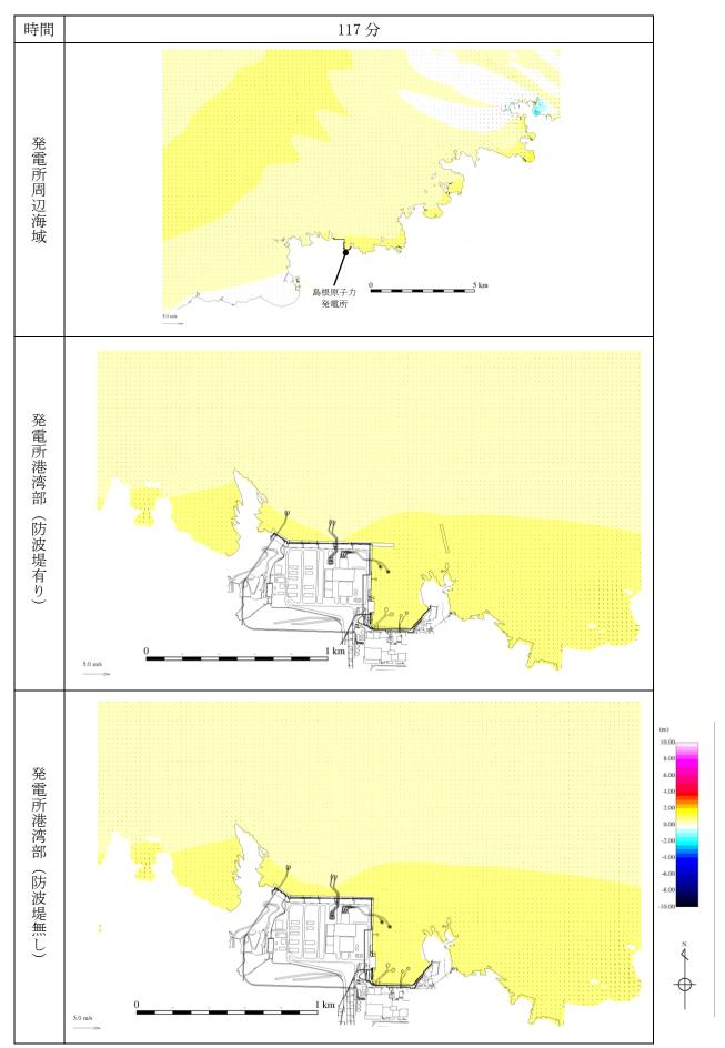
第 1 図(35) 基準津波 1 の水位変動・流向ベクトル
