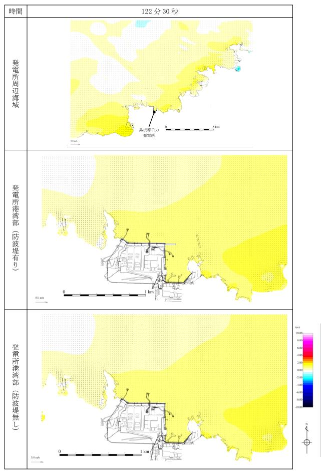
第 1 図(46) 基準津波 1 の水位変動・流向ベクトル
