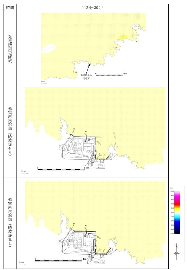
第 1 図(26) 基準津波 1 の水位変動・流向ベクトル
