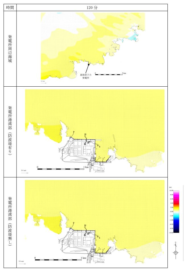
第 1 図(41) 基準津波 1 の水位変動・流向ベクトル
