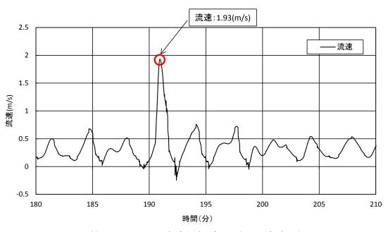
第2.5-32 図 流速評価結果(入力津波6)
