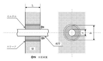
第4.2-23図 モルタル評価概要図
