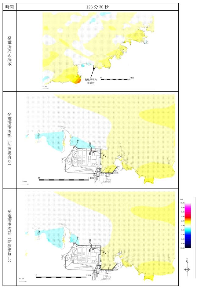
第 1 図(48) 基準津波 1 の水位変動・流向ベクトル
