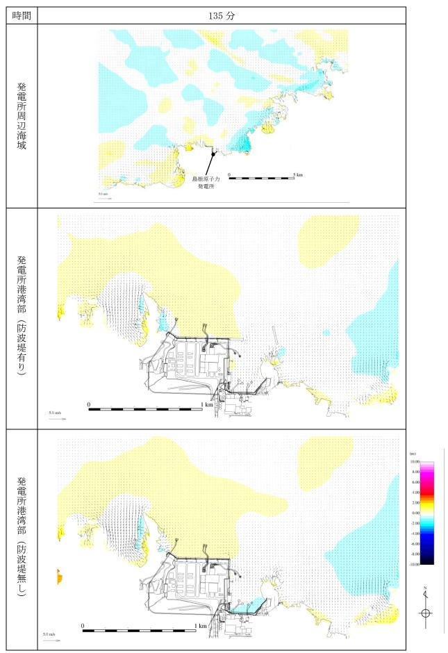
第 1 図(71) 基準津波 1 の水位変動・流向ベクトル
