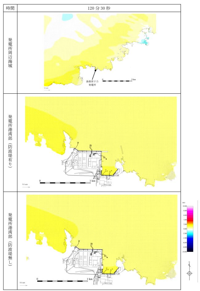
第 1 図(42) 基準津波 1 の水位変動・流向ベクトル
