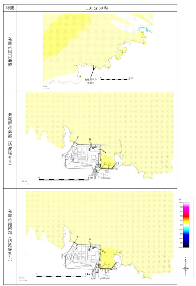
第 1 図(34) 基準津波 1 の水位変動・流向ベクトル
