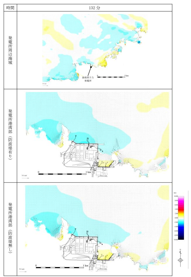
第 1 図(65) 基準津波 1 の水位変動・流向ベクトル
