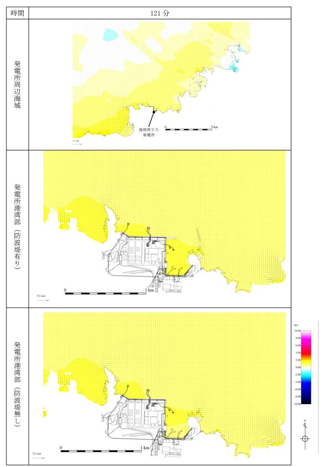
第 1 図(43) 基準津波 1 の水位変動・流向ベクトル
