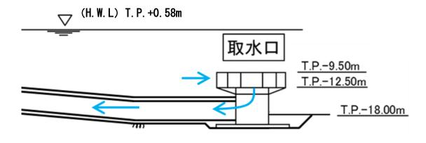
第2.5-6図 取水口呑口概要図
