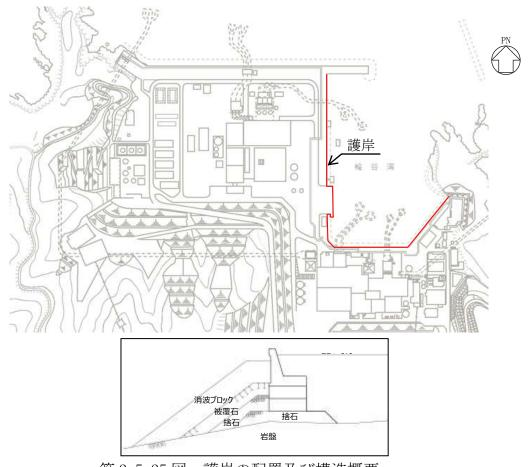
第2.5-25図 護岸の配置及び構造概要
