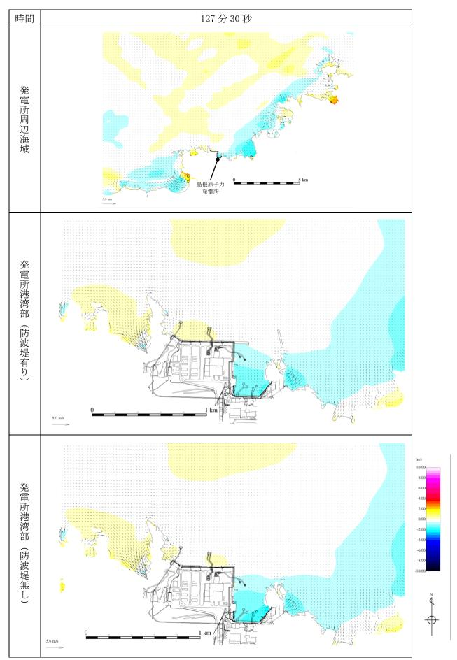
第 1 図(56) 基準津波 1 の水位変動・流向ベクトル
