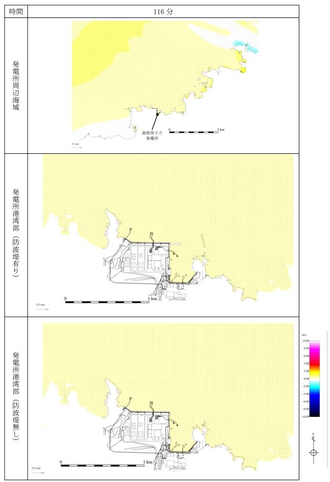
第 1 図(33) 基準津波 1 の水位変動・流向ベクトル
