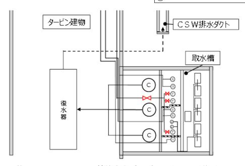
第4.2-14図 タービン補機海水ポンプ出口弁 設置位置
