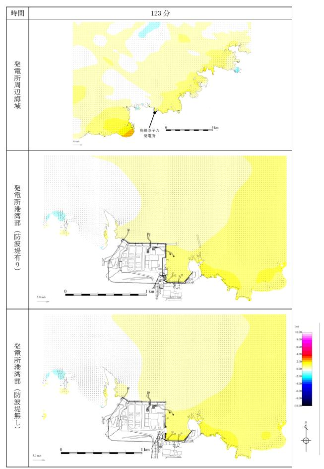
第 1 図(47) 基準津波 1 の水位変動・流向ベクトル
