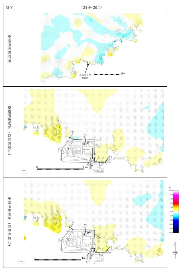
第 1 図(70) 基準津波 1 の水位変動・流向ベクトル
