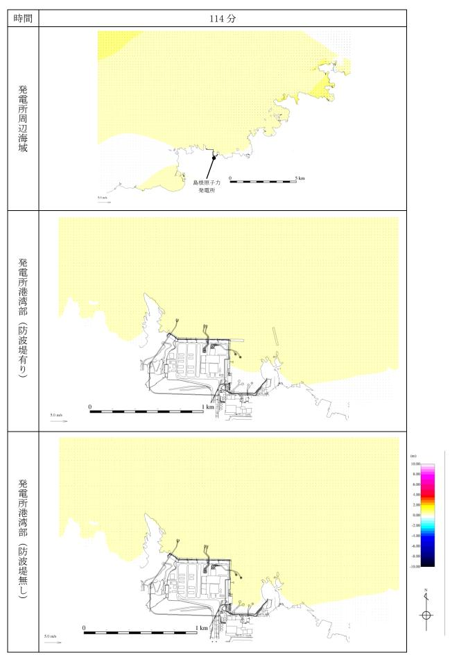
第 1 図(29) 基準津波 1 の水位変動・流向ベクトル
