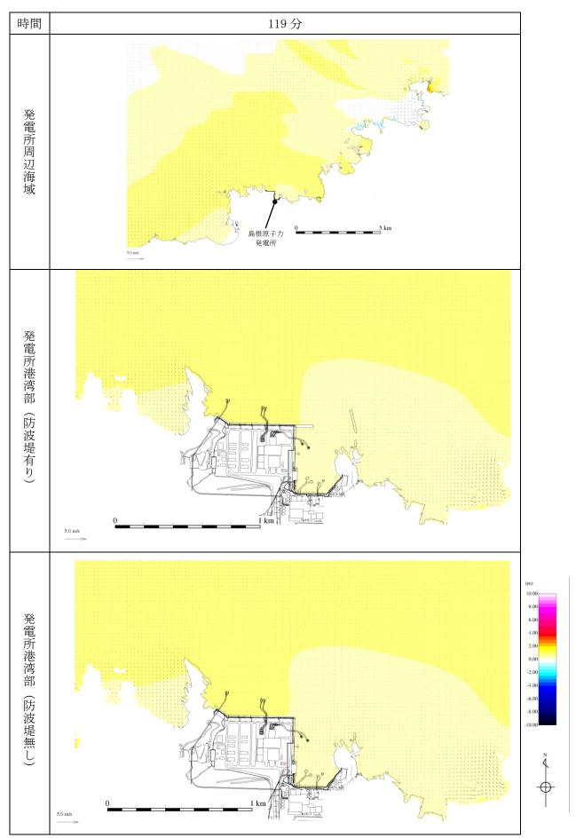
第 1 図(39) 基準津波 1 の水位変動・流向ベクトル
