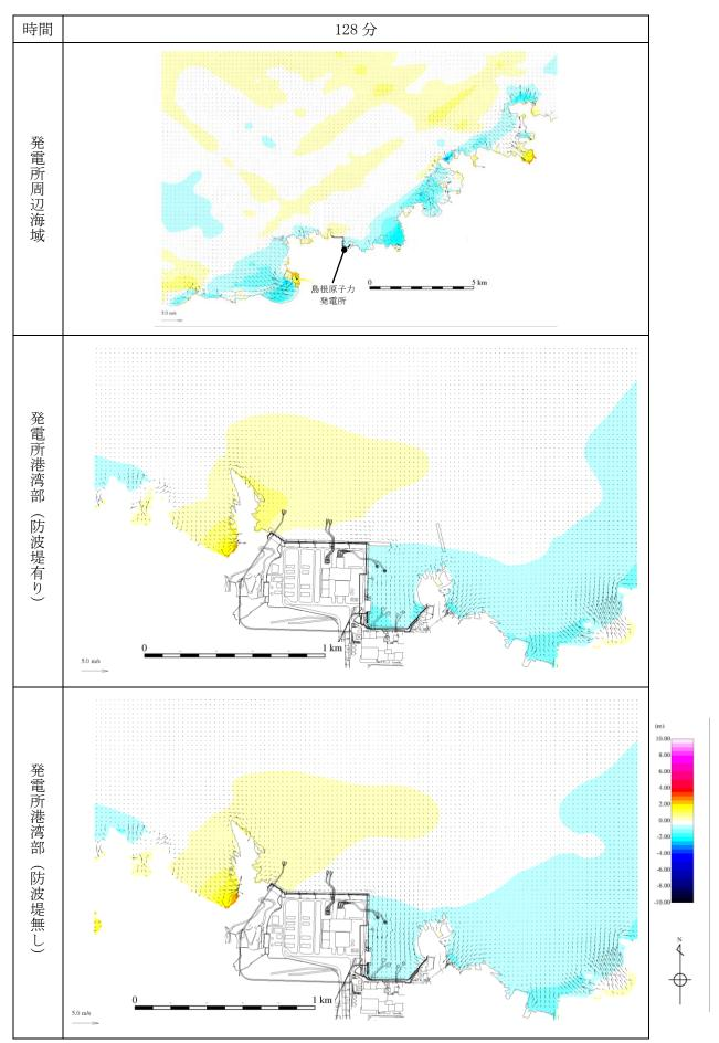
第 1 図(57) 基準津波 1 の水位変動・流向ベクトル
