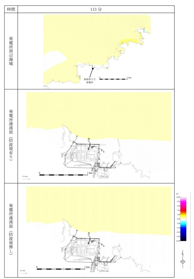
第 1 図(27) 基準津波 1 の水位変動・流向ベクトル
