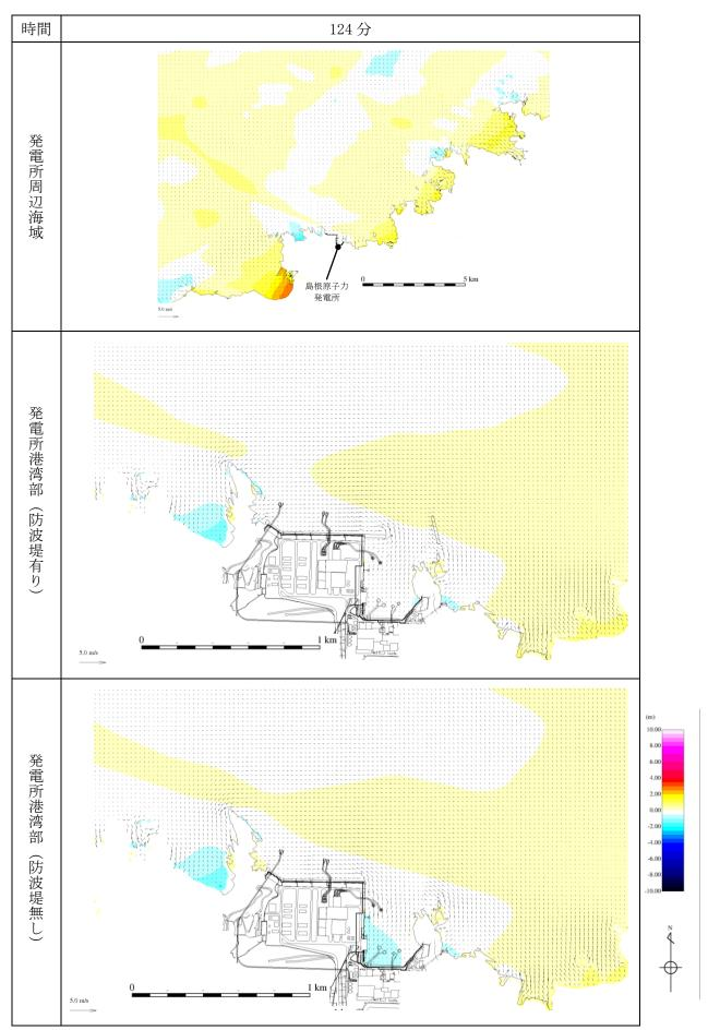
第 1 図(49) 基準津波 1 の水位変動・流向ベクトル
