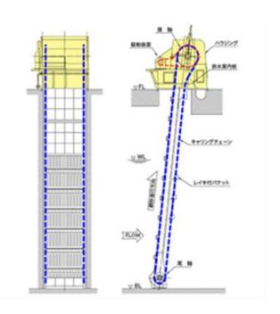
第 2.5-30 図 除塵装置の概要
