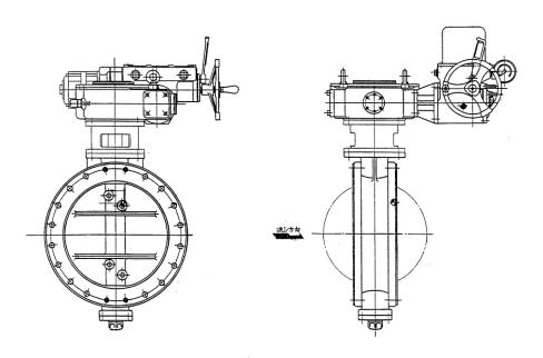
第4.2-15図 タービン補機海水ポンプ出口弁 構造例
