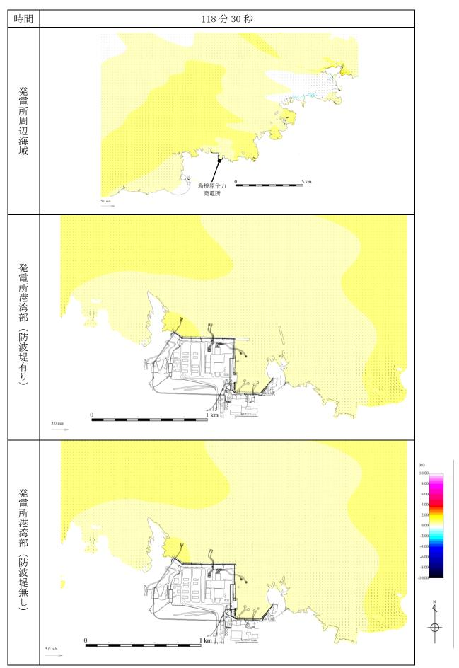
第 1 図(38) 基準津波 1 の水位変動・流向ベクトル
