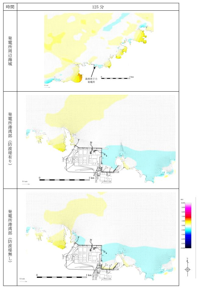
第 1 図(51) 基準津波 1 の水位変動・流向ベクトル
