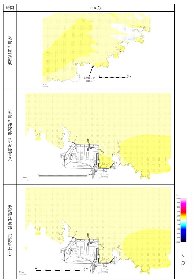
第 1 図(37) 基準津波 1 の水位変動・流向ベクトル
