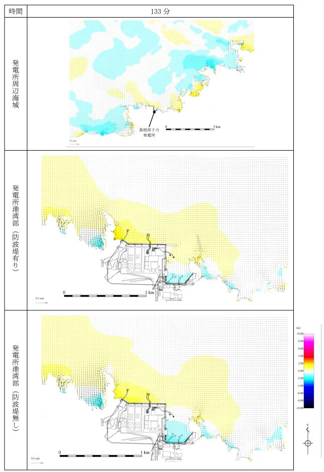
第 1 図(67) 基準津波 1 の水位変動・流向ベクトル
