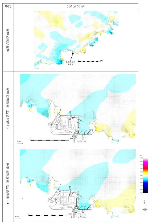
第 1 図(62) 基準津波 1 の水位変動・流向ベクトル
