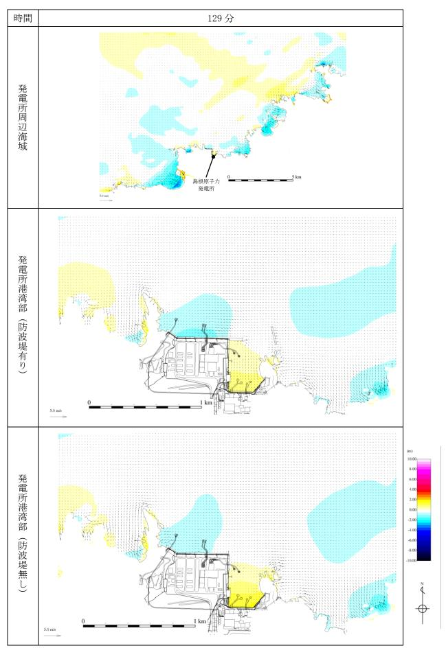
第 1 図(59) 基準津波 1 の水位変動・流向ベクトル
