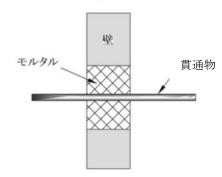
第4.2-22図 充填構造(モルタル)の概要
