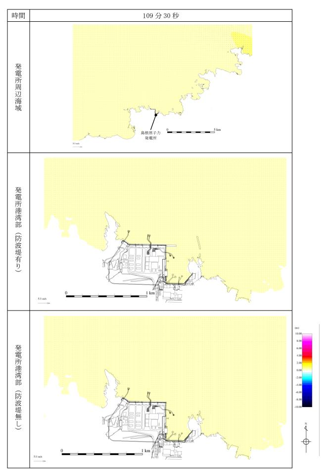
第 1 図(20) 基準津波 1 の水位変動・流向ベクトル
