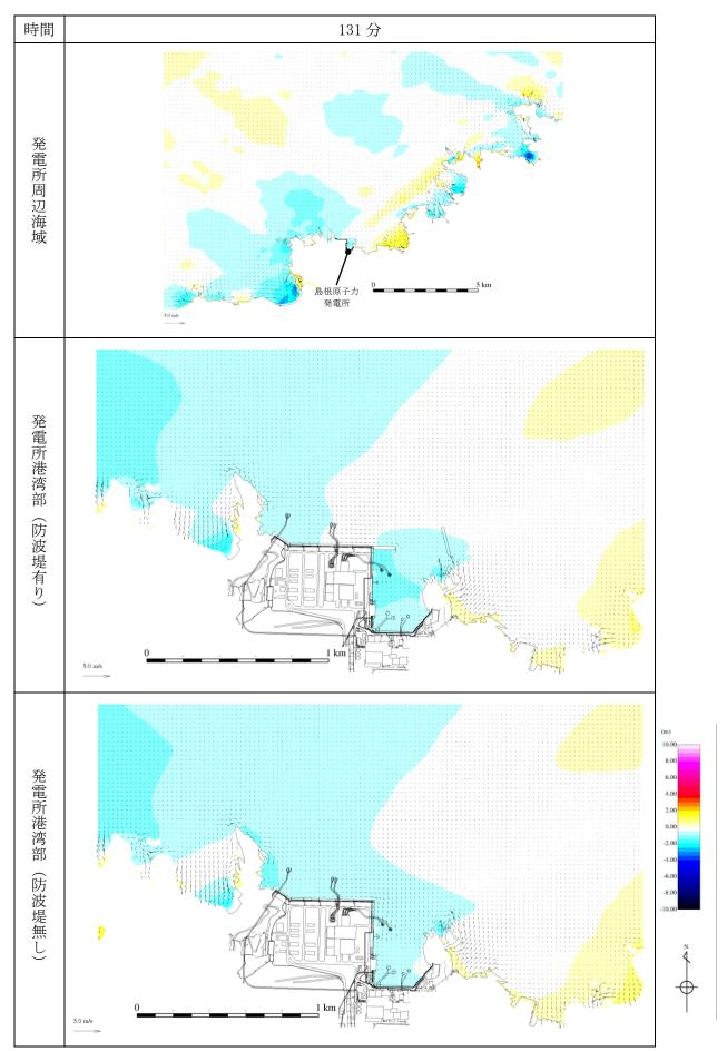
第 1 図(63) 基準津波 1 の水位変動・流向ベクトル
