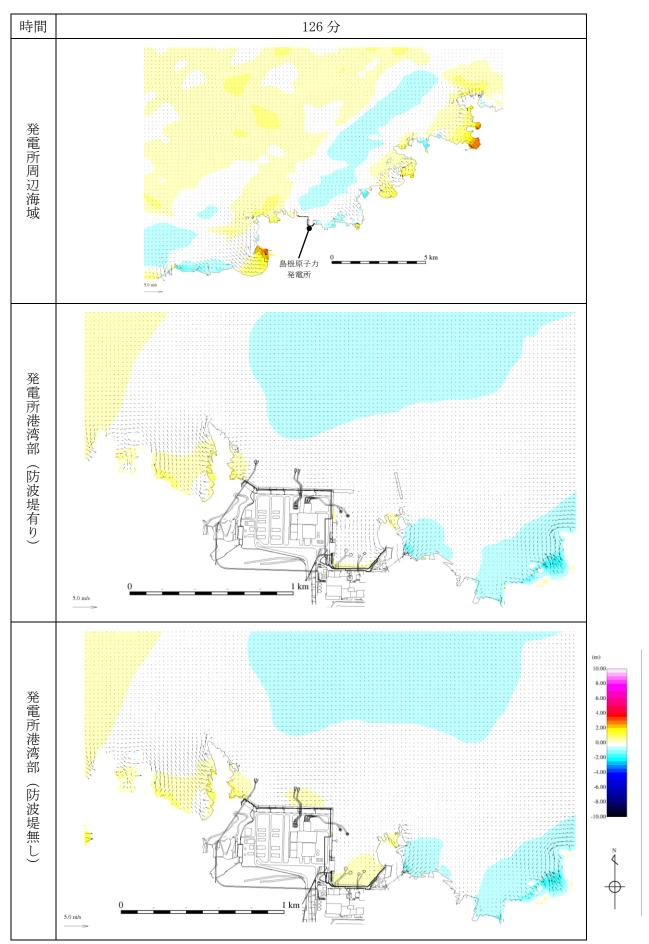
第 1 図(53) 基準津波 1 の水位変動・流向ベクトル
