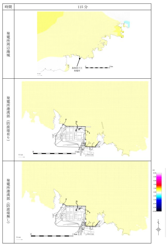
第 1 図(31) 基準津波 1 の水位変動・流向ベクトル
