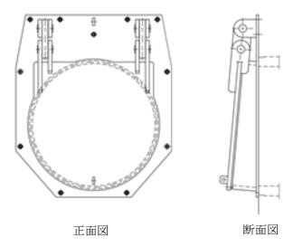
第4.2-3図 屋外排水路逆止弁構造例
