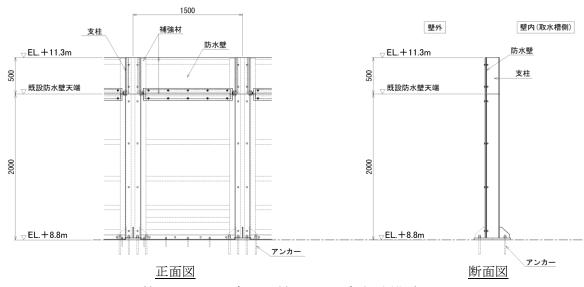
第4.2-5図 除じん機エリア防水壁構造図
