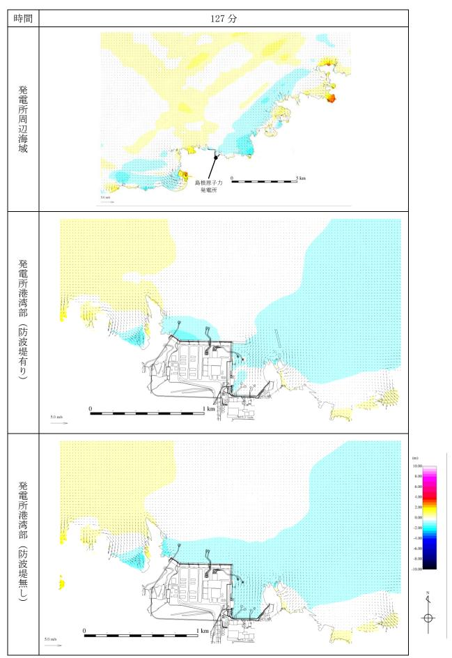
第 1 図(55) 基準津波 1 の水位変動・流向ベクトル
