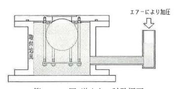
第4.2-12 図 逆止弁の試験概要
