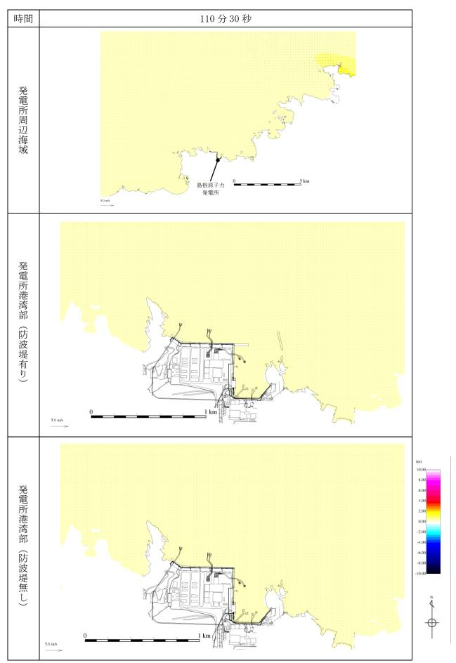
第 1 図(22) 基準津波 1 の水位変動・流向ベクトル
