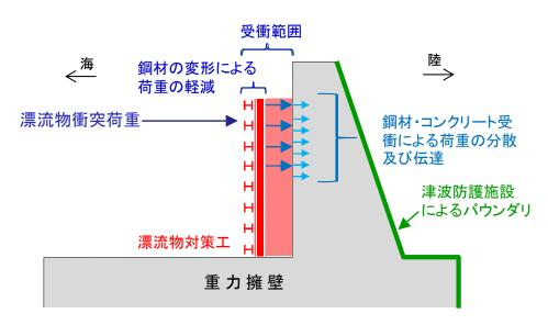
図-21 防波壁(波返重力擁壁)の漂流物対策工における荷重図
