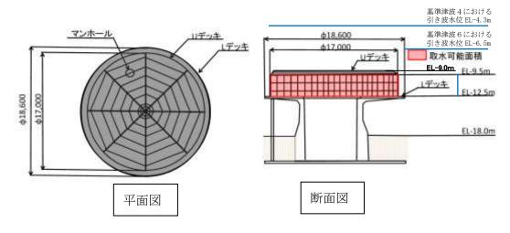
第2.5-23 図 取水口呑口概要図
