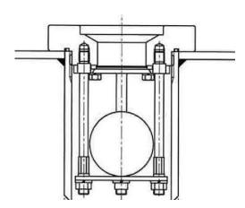
第4.2-11図 床ドレン逆止弁の構造の例
