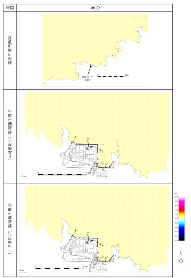
第 1 図(17) 基準津波 1 の水位変動・流向ベクトル
