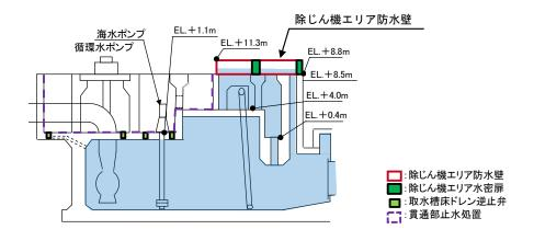
第4.2-4図 除じん機エリア防水壁配置図
