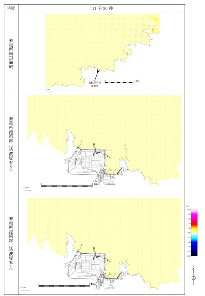
第 1 図(24) 基準津波 1 の水位変動・流向ベクトル
