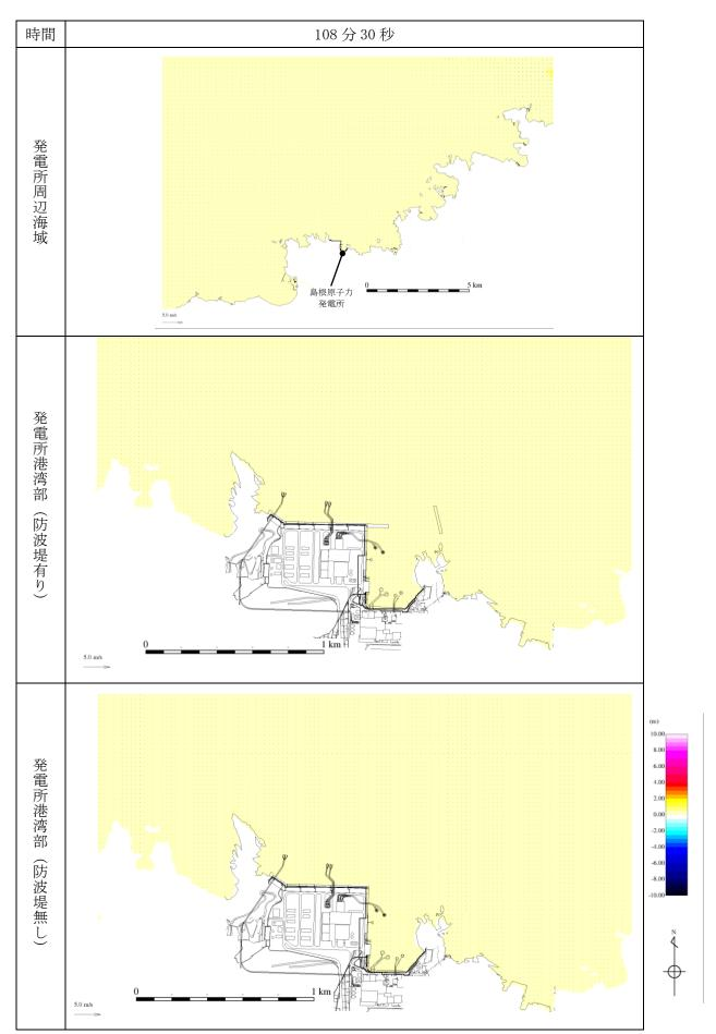
第 1 図(18) 基準津波 1 の水位変動・流向ベクトル
