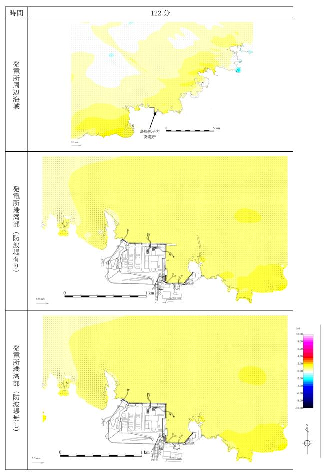
第 1 図(45) 基準津波 1 の水位変動・流向ベクトル
