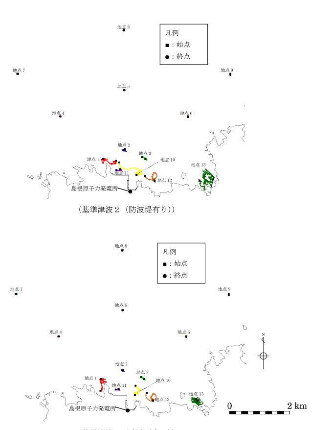
(基準津波3 (防波堤有り)) 第2.5-14-2 図 軌跡解析結果
