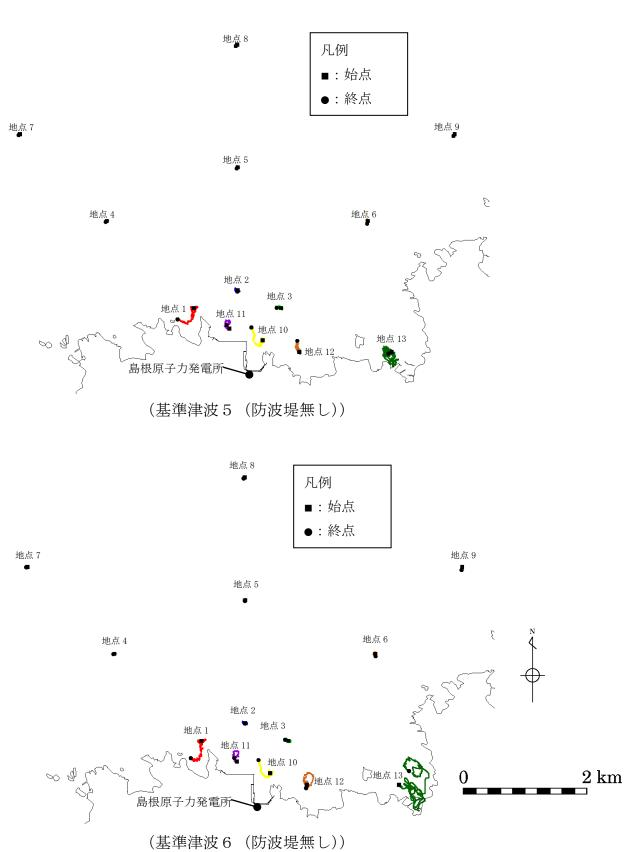
(基準津波 6 (防波堤無し)) 第 2.5-14-3 図 軌跡解析結果
