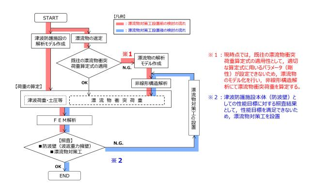
図-23 (例) 津波防護施設 (防波壁:波返重力擁壁) における漂流物対策工 に係る検討の流れ (総トン数19t:FRP 製)
