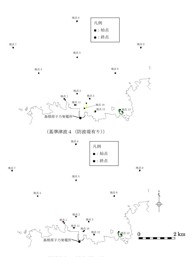
(基準津波4 (防波堤無し)) 第2.5-14-4図 軌跡解析結果
