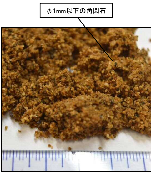
当該地点で採取した三瓶浮布テフラの接写写真 φ 1mm以下の角閃石を含む。
