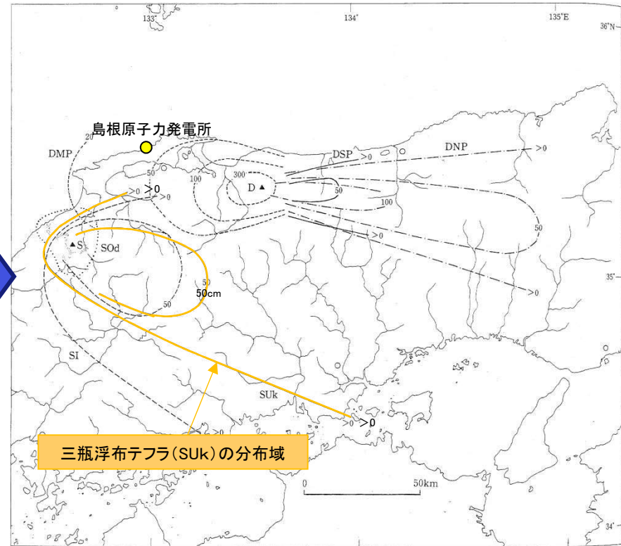
図 3.2-1 中国地方の後期更新世主要テフラの等層厚線図。 Suk 三瓶浮布 1,4-7) など SI 三瓶池田 1) など SOd 三瓶大田 1) など (点線内が pfi 分布域) DSP 大山関金 2,3) DNP 大山生竹 2,3) DMP 大山松江 2,3) D:大山, S:三瓶 [1] 林・三浦(1987), 2) 町田・新井(1979), 3) 津久井(1984), 4) 竹村ほか(1994), 5) 吉川ほか(1986), 6) Ooi(1992), 7) 加藤ほか(1996)]
