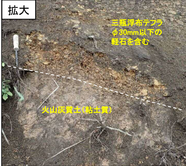
当該地点で採取した三瓶浮布テフラの接写写真 φ1mm程度の角閃石を含む。
