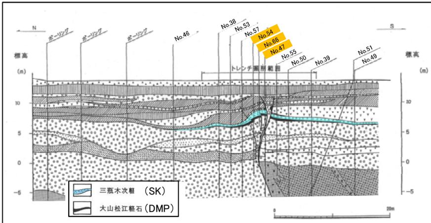
・南講武トレンチ掘削範囲(突道断層付近)で実施したボーリング結果によると、SK層及びDMP層が確認されるが、いずれも不純物を混在する、または、堆積構造等が認められることから再堆積層と判断した。
