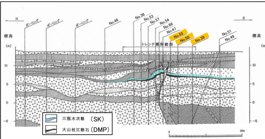
・南講武トレンチ掘削範囲の宍道断層南側で実施したボーリング結果によると、SK層及びDMP層が確認されるが、いずれも不純物を混在する再堆積層と判断した。
