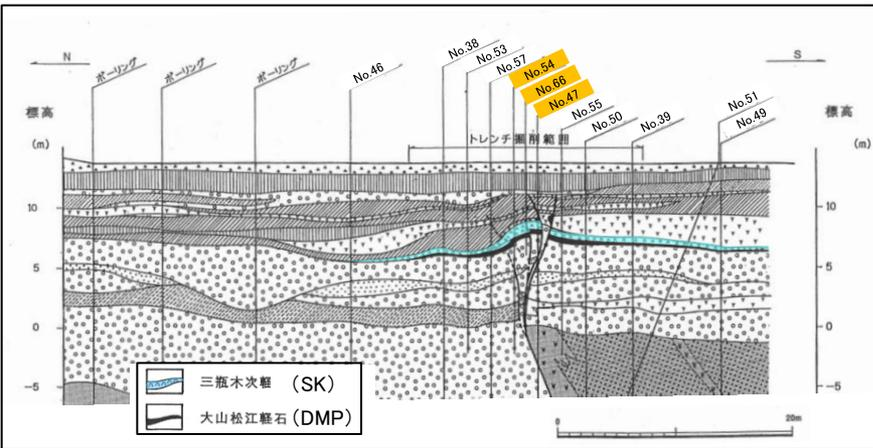
・南講武トレンチ掘削範囲(宍道断層付近)で実施したボーリング結果によると, SK層及びDMP層が確認されるが, いずれも不純物を混在する, または, 堆積構造等が認められることから再堆積層と判断した。
