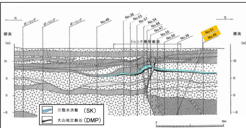
・南講武トレンチ掘削範囲の南側で実施したボーリング結果によると、SK層及びDMP層が確認されるが、いずれも堆積層中に木片や異質岩片などの不純物を混在する再堆積層と判断した。
