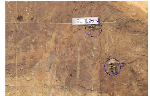
P12: 径5cm～数mm程の炭化木片が散在している。
