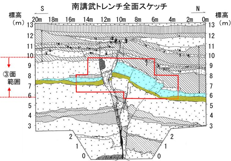
断層面の走向傾斜 N85W, 80S
