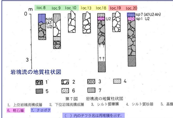
・野村(1991)は、広島県北東部の道後山周辺の緩斜面な山頂付近の凹地に見られる巨岩塊で構成された地形や山麓に形成された麓層面の地質柱状図を作成しており、調査域のほとんどで三瓶浮布軽石(U<sub>2</sub>)が認められることを報告している。
