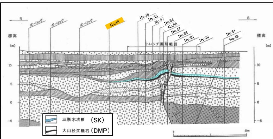
・南講武トレンチ掘削範囲の北側で実施したボーリング結果によると、SK層及びDMP層が確認されるが、いずれも不純物を混在する再堆積層と判断した。
