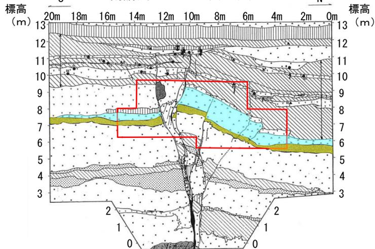
断層面の走向傾斜 N85W, 80S
