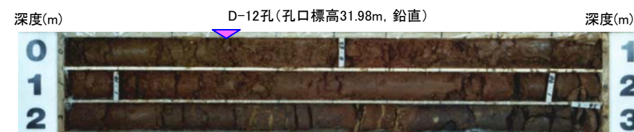
コア写真(D-12孔 深度0~3m) 岩盤(深度0.30m~)の上位には表土のみ認められる
