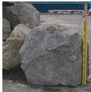
被覆石寸法（1，2号炉北側護岸）
