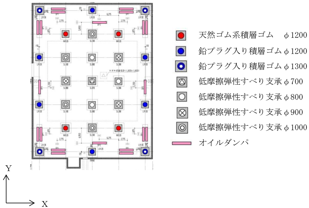
第3図 免震装置配置図
