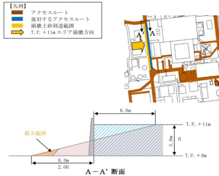
第 5.5.1-6 図 崩壊土砂撤去の考え方
