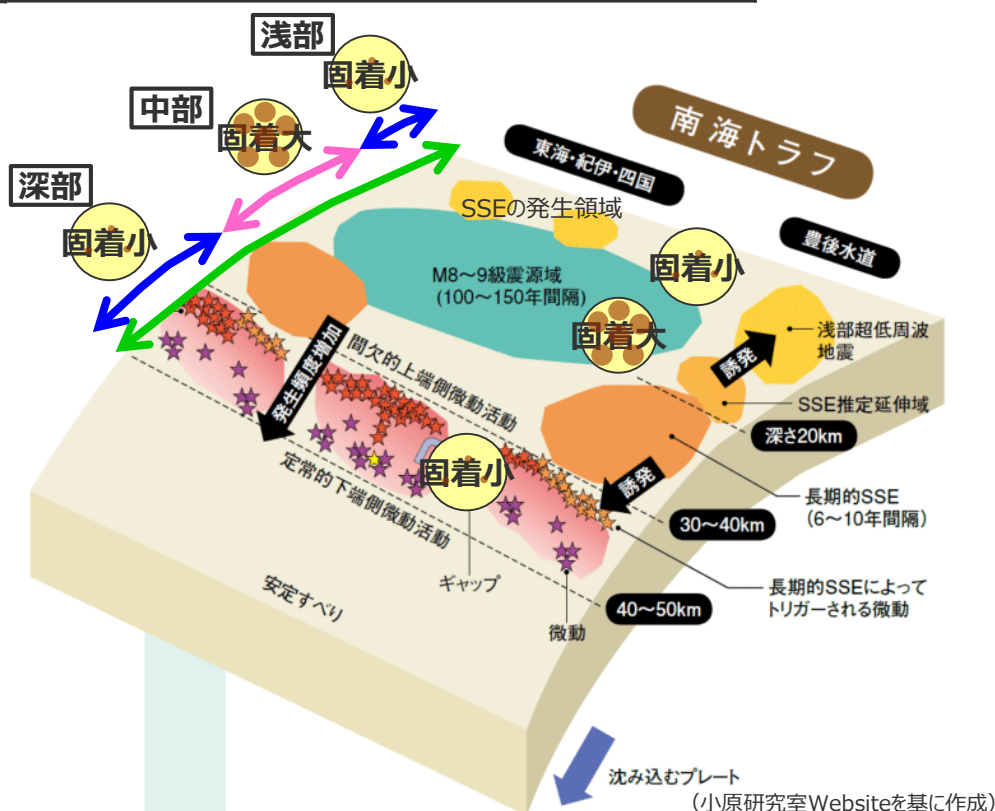
西南日本における低周波振動現象と固着域の関係の模式図 (小原研究室Websiteを基に作成)
