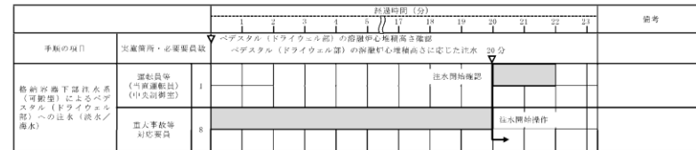
第1.8-7図 格納容器下部注水系（可搬型）によるペDESTAL（ドライウエル部）への注水（淡水/海水）タイムチャート
