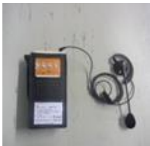
有線式通信設備 (有線式通信機)
