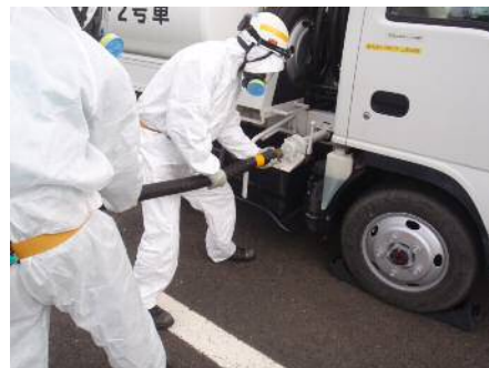
タンクローリへのホース接続
