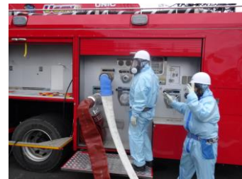
ポンプ起動操作（昼間）
