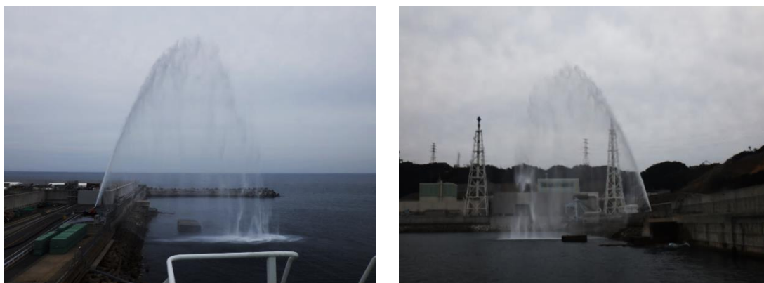
第4図 直状放射による放水
