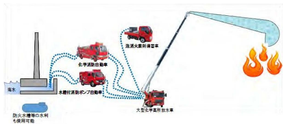
図 8-1 大型化学高所放水車による泡消火
