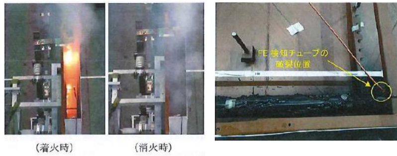
第 9 図：試験 V1 における発火・消火時の状態
