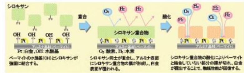
図 (添付 1-3) シロキサンによる触媒表面の変化状況 (イメージ) ※ 図 (添付 1-1~3) は参考文献(a)より引用。
