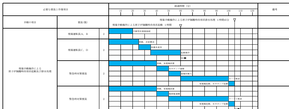
図3.2-6 現場手動操作による原子炉隔離時冷却系起動のタイムチャート*
