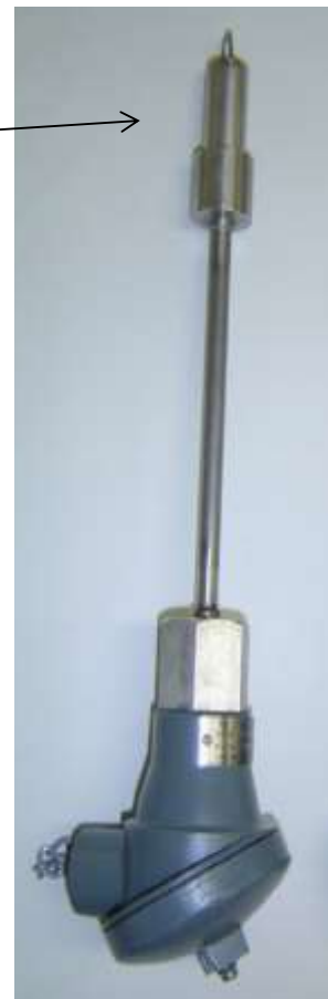
第1図 通電式ナトリウム漏えい検出器（プラグ型）の構造概要
