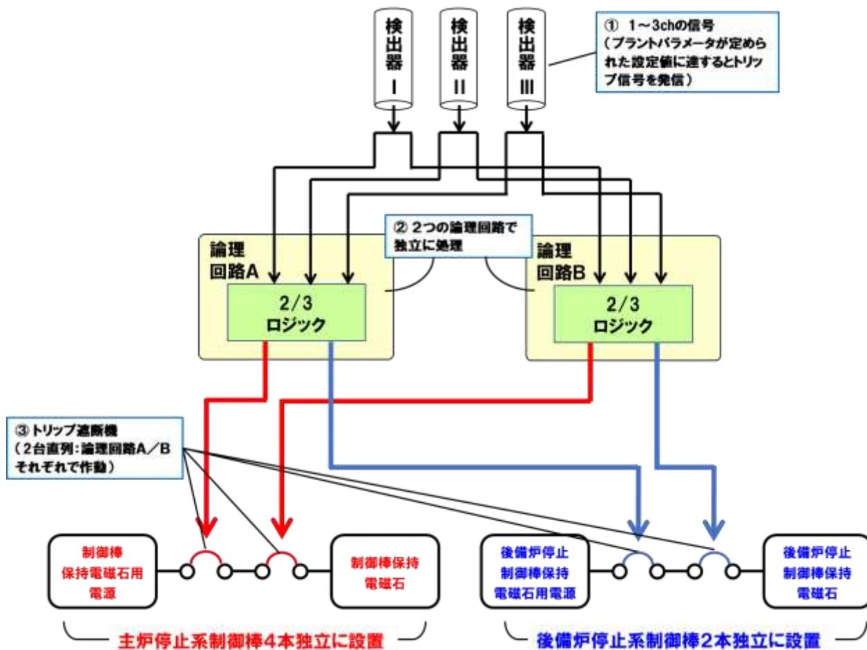
第5図 原子炉停止系統の概要
