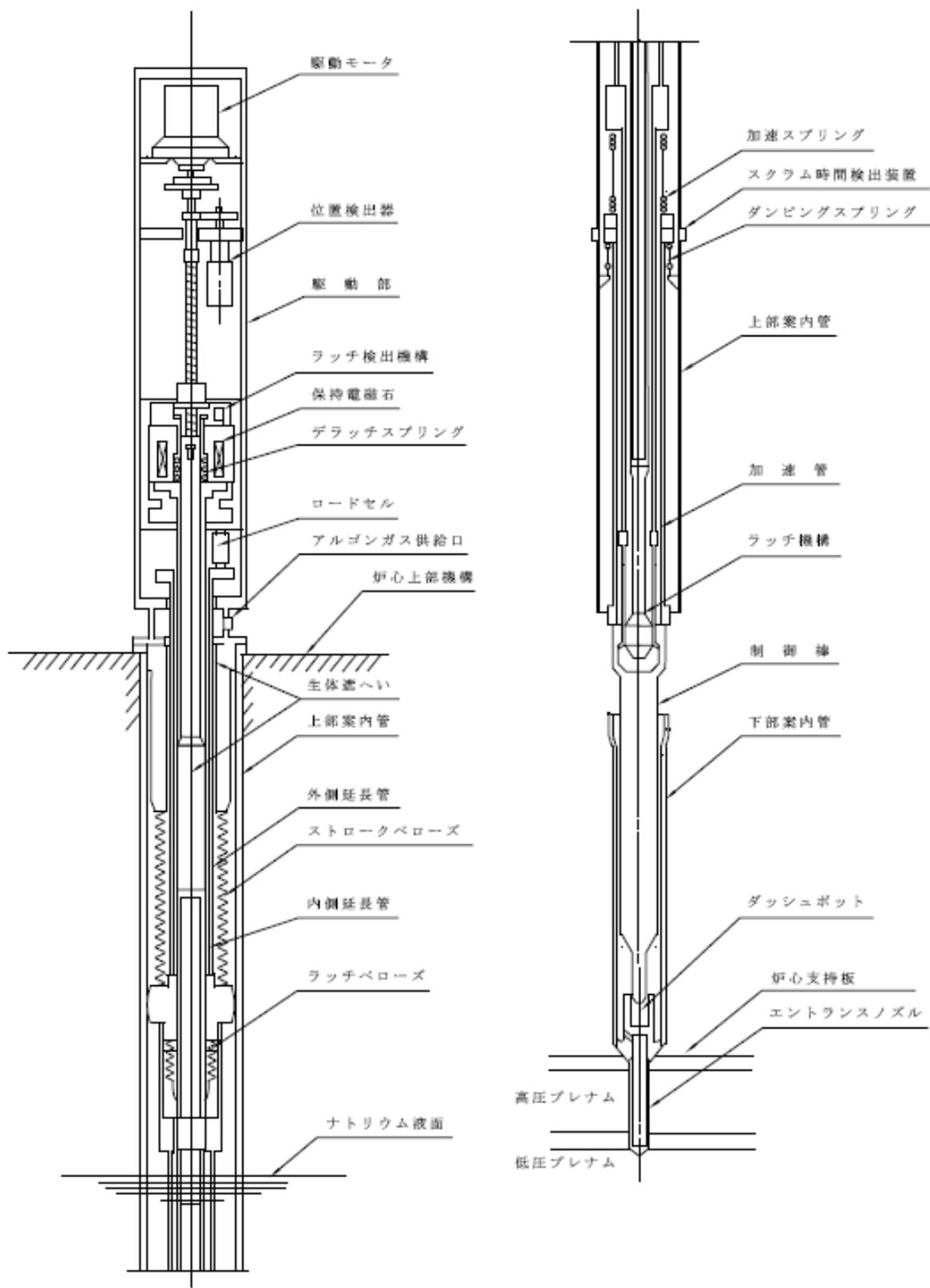
第7図 制御棒駆動機構の構造
