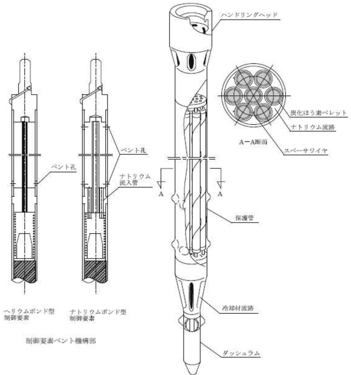
第6図 制御棒の構造
