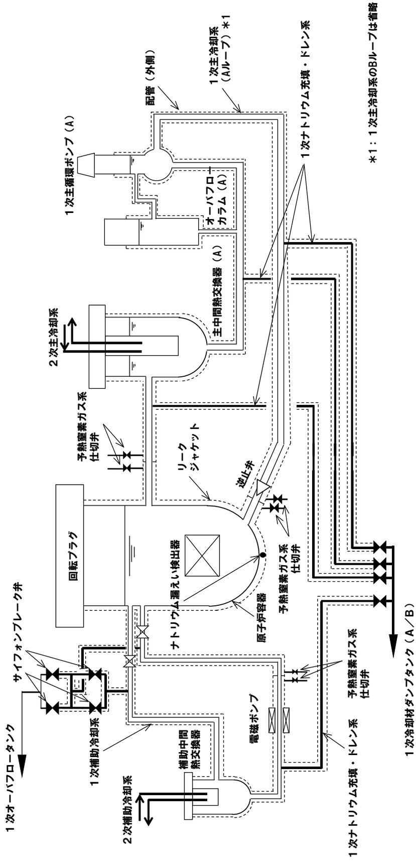
第3図 原子炉冷却系統施設の構造概要 (2/3)
