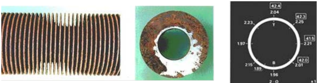
第2図 過去の主冷却器伝熱管の肉厚確認結果（一例）
