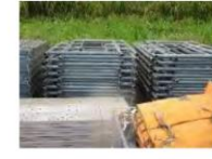
③-42 仮設足場枠組材
