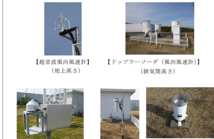
【日射計 (左), 放射収支計 (右)】 【温度計】 【雨量計】
