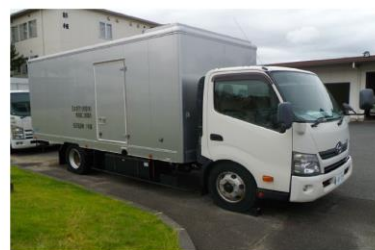
可搬型代替低圧電源車
