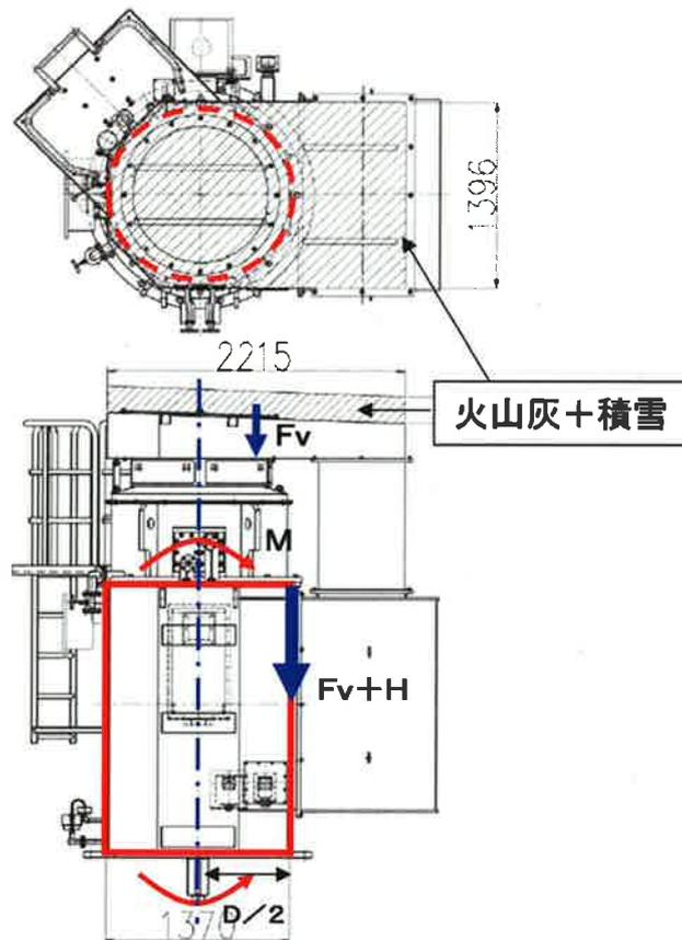
図 1 海水ポンプモータフレーム構造
