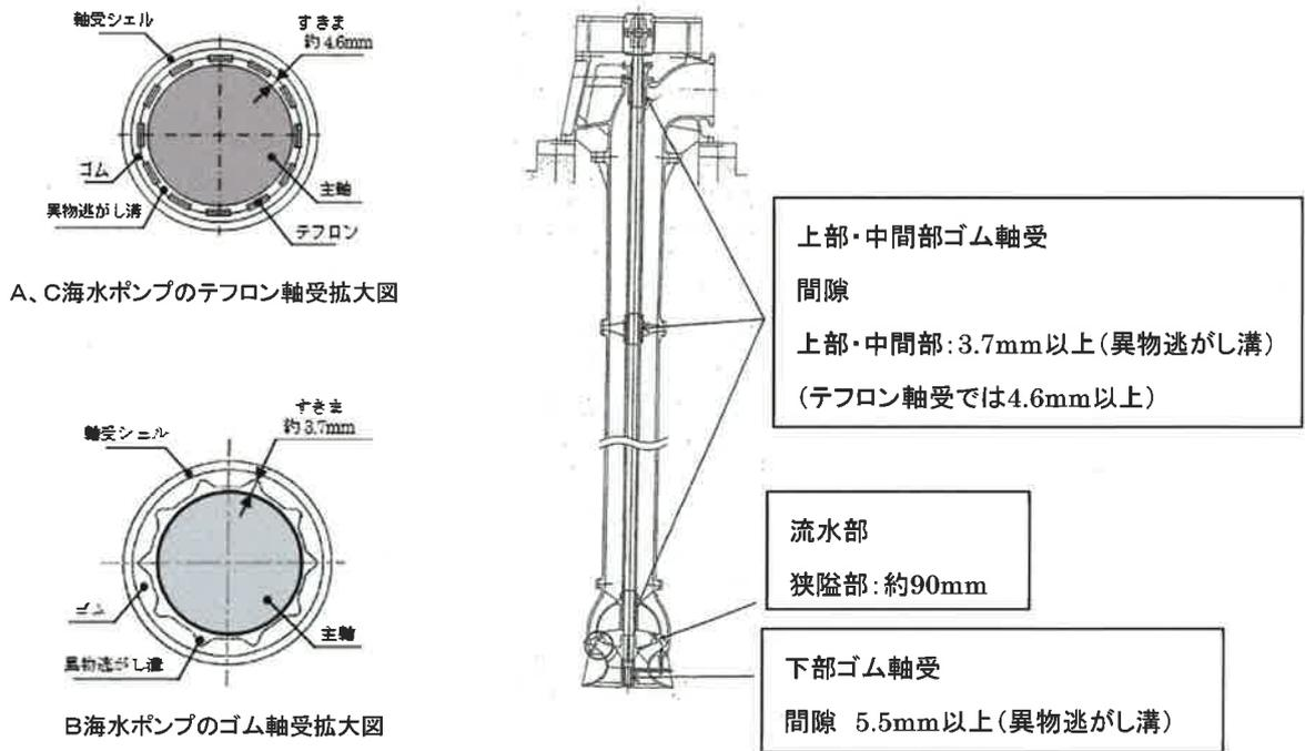
図3 海水ポンプ軸受構造図
