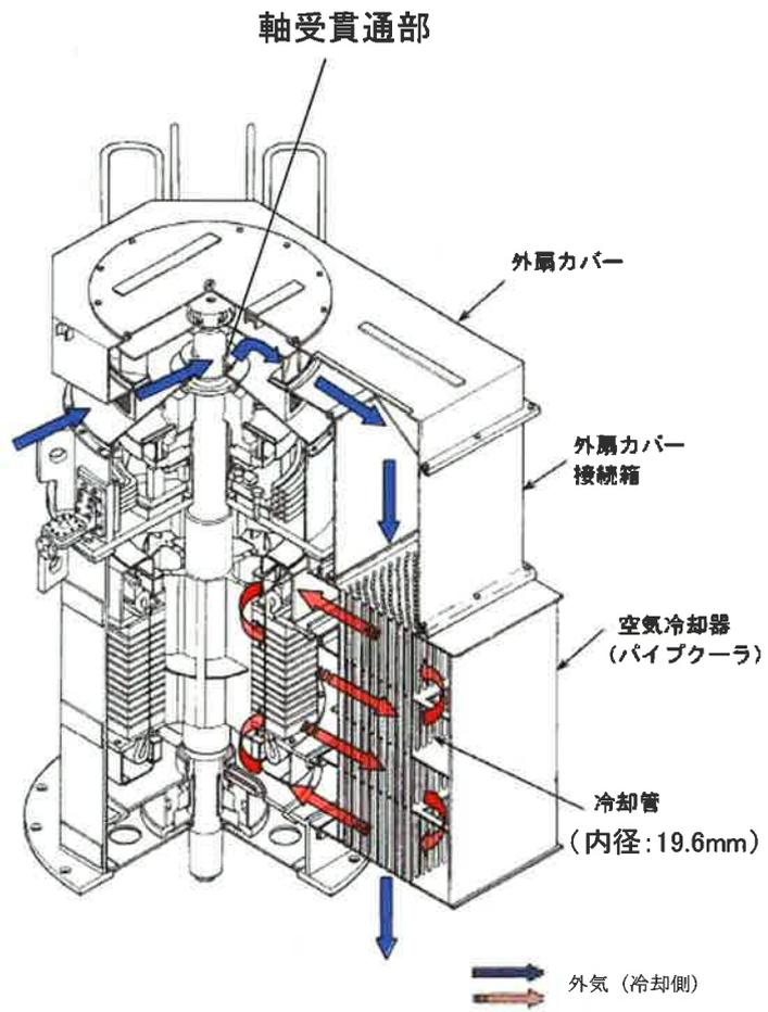
図4 海水ポンプモータの冷却方式
