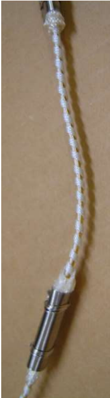
第2図 通電式ナトリウム漏えい検出器（リボン型）の構造概要
