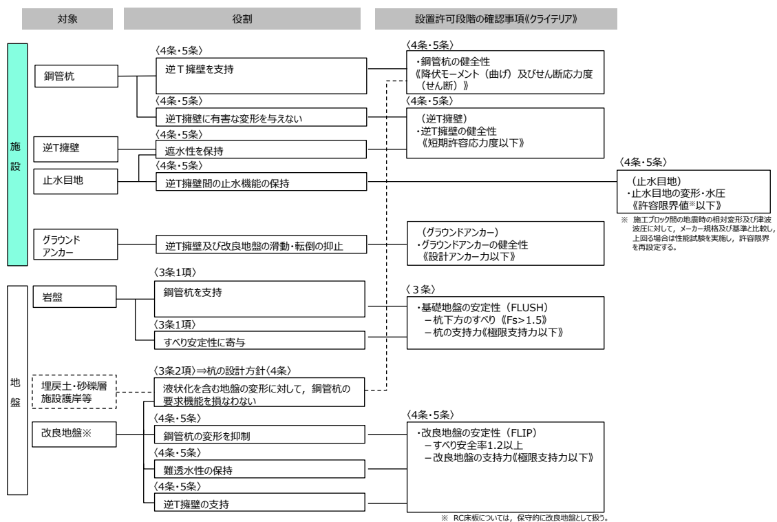
第9-2図 設置許可段階における確認項目 [防波壁（鋼管杭式逆T擁壁）]
