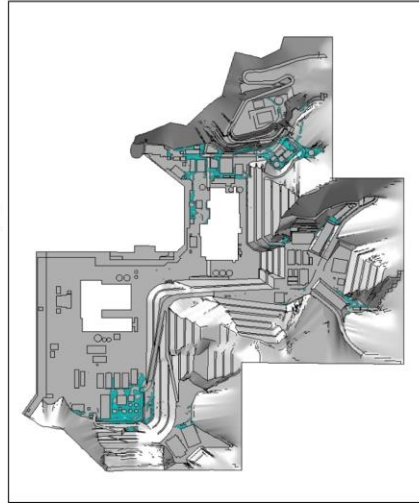
図 10-3-2 屋外タンクの溢水伝播挙動 (1/2)
