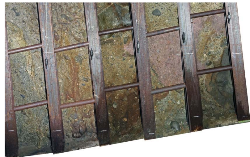
断層延長位置付近の大畑層の性状(解釈線なし)
