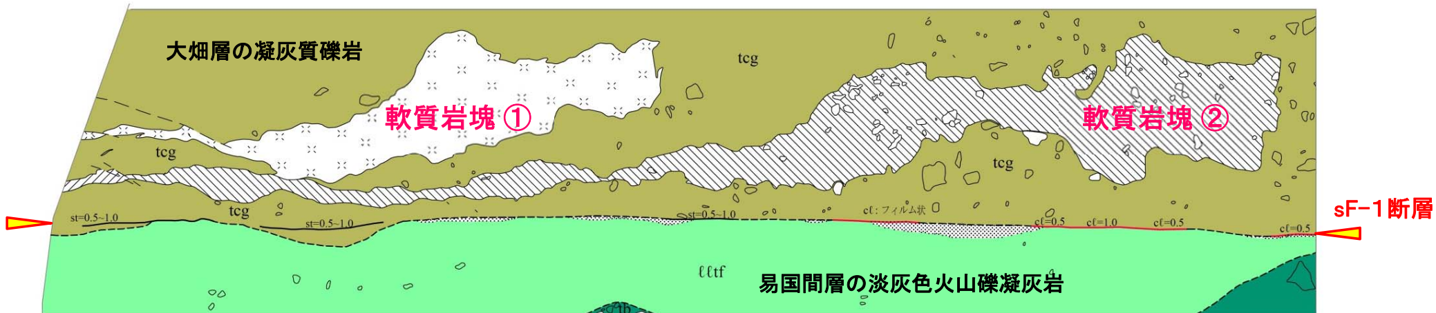
掘削面底盤Aの地質スケッチ
