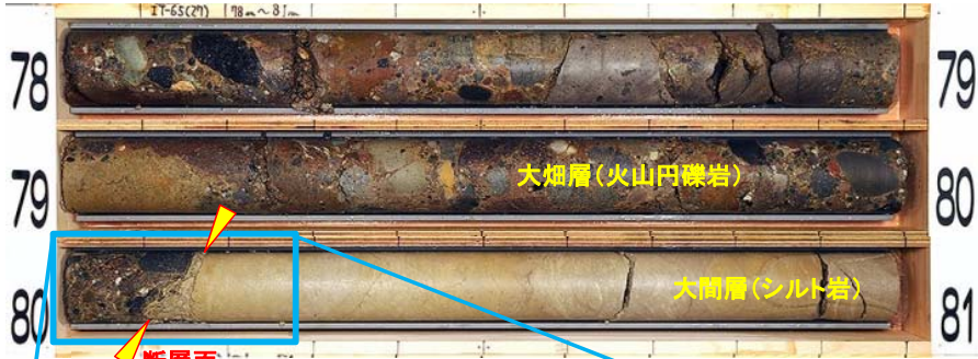
断層面 (粘土状破碎部)
