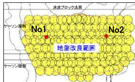
PS検層実施箇所
